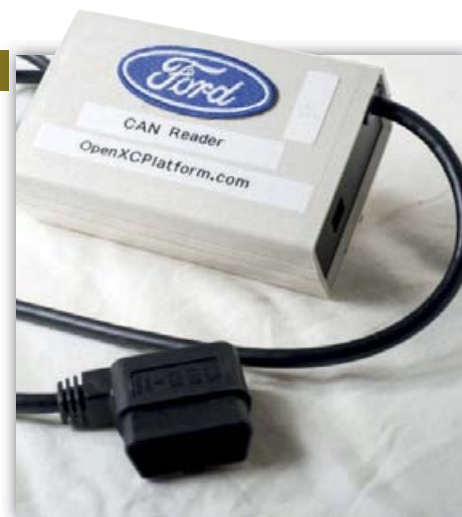
CAN Translator: Uređaj za prikupljanje podataka iz Ford vozila
