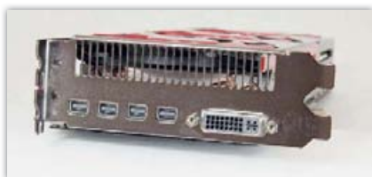
Pet video izlaza: Od čega četiri mini DisplayPorta
